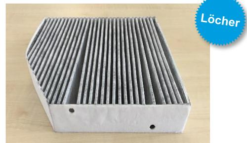
**Bild 2:** Die OE-Filter sind mit zwei Löchern versehen. Zwei im Gehäuse befindliche Zapfen dringen in die Filter ein.
