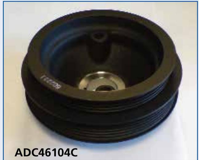
Wenn die Kurbelwellen-Riemenscheibe einen abgenutzten Gummidämpfer hat, kann sie bei hohen Motordrehzahlen schwingen und in extremen Fällen kann es vorkommen, dass sich der äußere Teil der Riemenscheibe ablöst.
