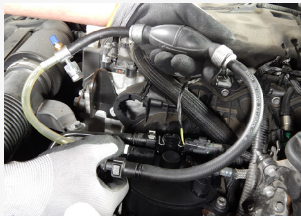
Abbildung 2 Entlüftungswerkzeug für das Kraftstoffsystem installiert und einsatzbereit
