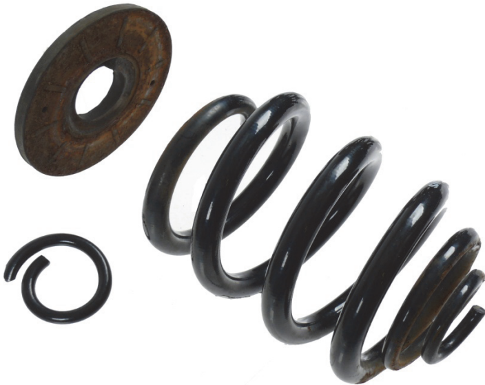
Abb.1: Verschlissener Federteller und gebrochene Fahrwerkfeder
