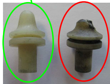
Vergleich einer neuen Auflagekugel mit einer abgenutzten.
